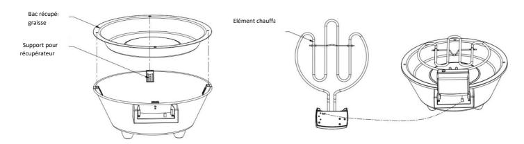
3- Positionnez le bac récupérateur de graisse en aluminium sur les supports et alignez les trous du bac et des supports. Le réservoir doit être rempli d'eau entre les marquages MIN et MAX ; ne jamais mettre d'eau sur l'élément chauffant ou le thermostat.
