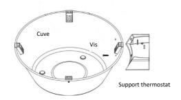
1-Fixer le support du thermostat à la cuve à l'aide des vis
