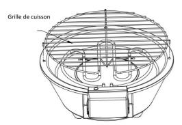
5 – Positionnez la grille de cuisson sur l'élément chauffant en vous assurant de l'aligner dans les trous du bac de récupérateur de graisse.
